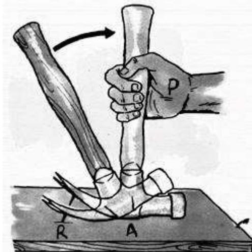
Ésta es una Máquina Simple: Palanca para sacar un Clavo.
